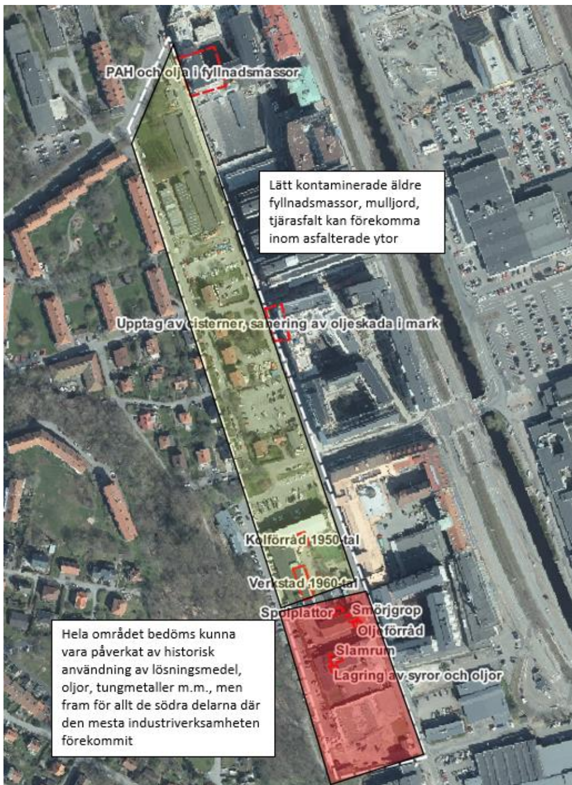
Figur 13. Flygbild över detaljplaneområdet med föroreningshypotes markerat. Inom rödmarkerat område har bland annat lösningsmedel, både aromatiska och klorerade, hanterats.
